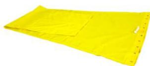
**CONE DE VENTO** CONFECCIONADO EM MATERIAL 100% NYLON COM DUAS CAMADAS DE RESINA, RHODIA 240/34 FIOS, TRAMA DTEX-F, 240/24 FIOS URDUME DTEX-F, ARMAÇAO DO TECIDO 1,1 EM TELA, GRAMATURA 116 G/M2, ESPESSURA MICRA, IMPERMEAVEL, ANTIFUNGOS, ULTRAVIOLETA, COM ILHOSES E CORDAO DE POLIESTER PARA AMARRACAO E REFORÇO NO DIAMETRO DE ENTRADA E SAIDA.
