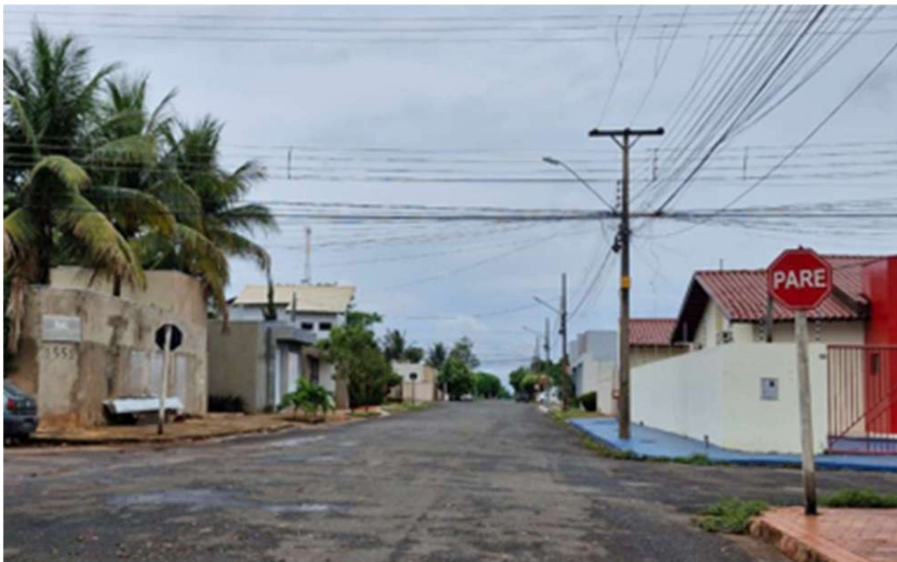
Foto 54: Ausência de sinalização de solo reforçando a necessidade de parada obrigatória, situação encontrada em diversos pontos da cidade (autor – 2024).
