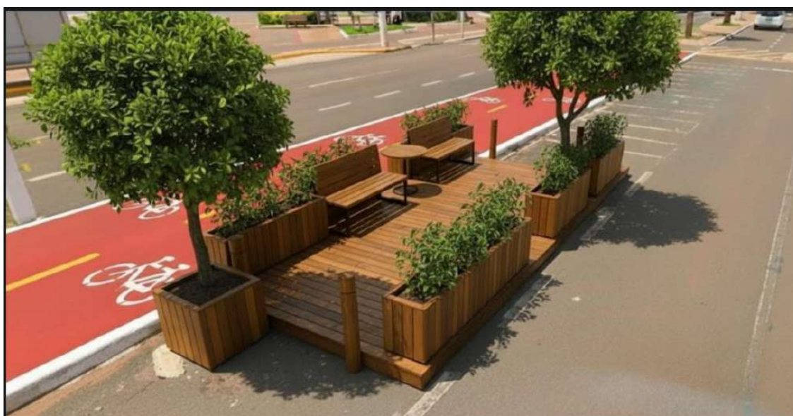
Imagens 26 e 27: Exemplo de implantação de ciclovia compartilhada, mantendo o estacionamento junto ao canteiro central e criando área e convívio.
