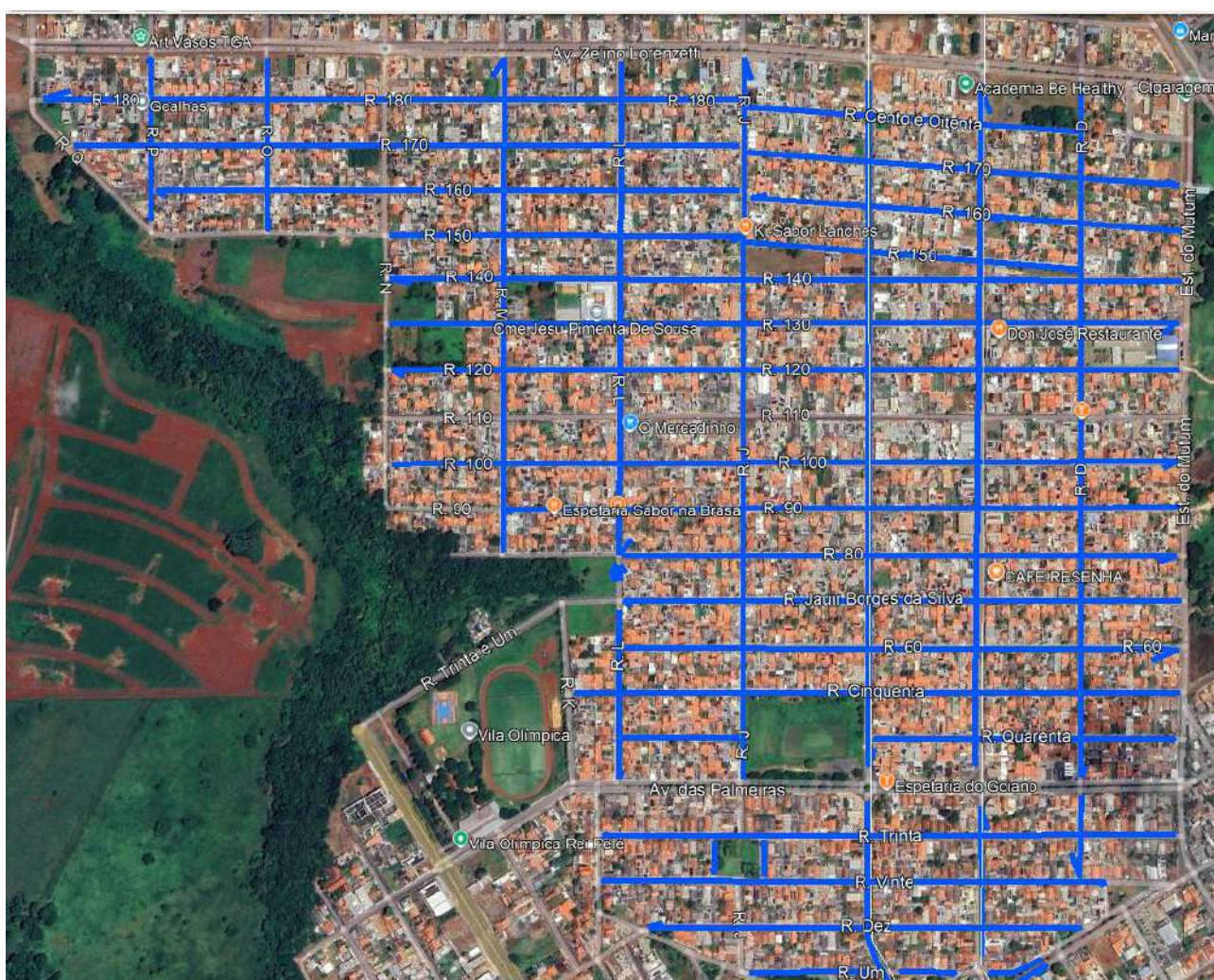
Imagem 04: Vias do Bairro Tarumã que tem sentido único de circulação, passíveis de extensão de área de circulação por projeto de faixa azul (em São Paulo era faixa verde) com separação dos fluxos veiculares com o uso de tachões e sinalização vertical. Esta medida seria aplicada apenas para as vias locais.
